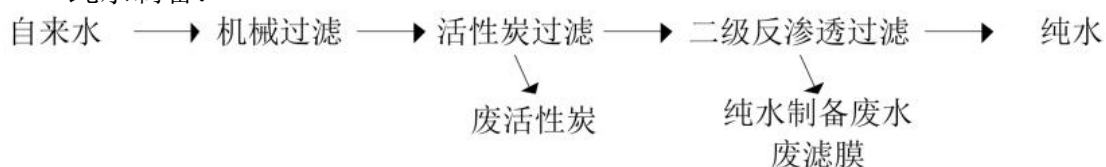
图 3-5 纯水制备生产工艺及产污流程图
